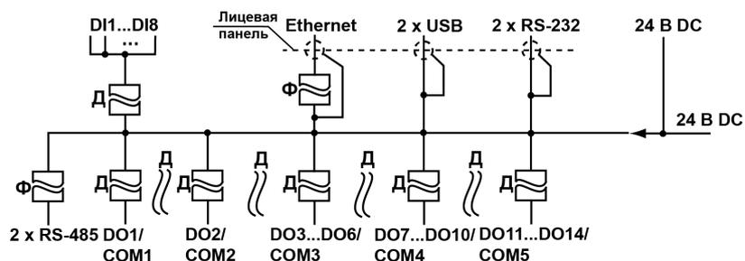
Рисунок 2.4 – Схема электрической прочности изоляции ПЛК110-24.X.K(M02)
