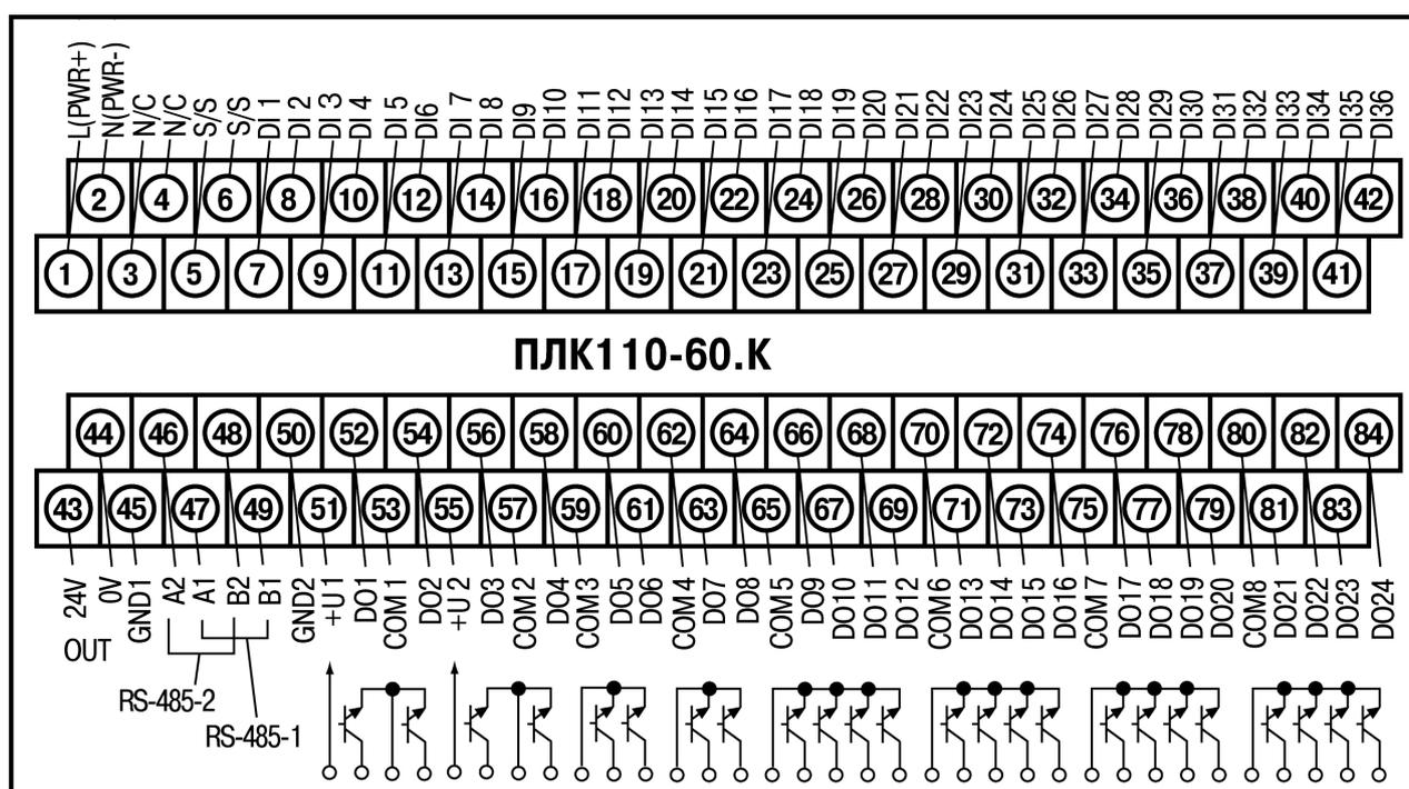
Рисунок 6.6 – Схема расположения и назначение клемм на ПЛК110-24.60.K(M02).
