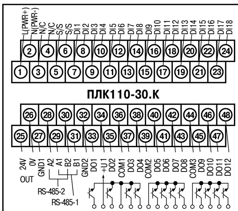
Рисунок 6.2 – Схема расположения и назначение клемм на ПЛК110-220.30.K(M02).
