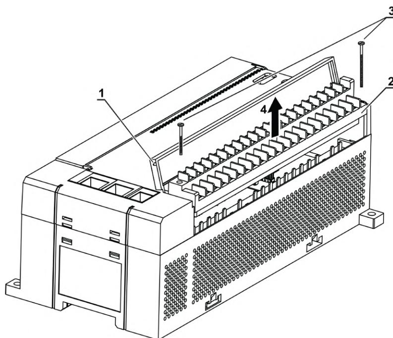
**Рисунок 3.5 – Отсоединение клемм**
