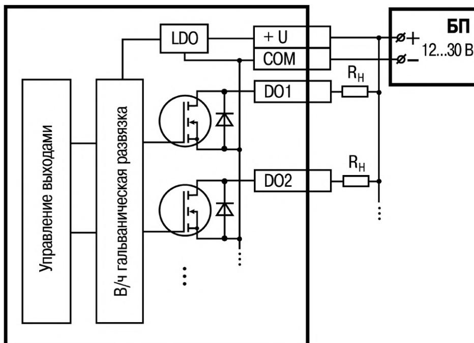
Рисунок 6.11 – Выходные элементы типа К (быстродействующие)
