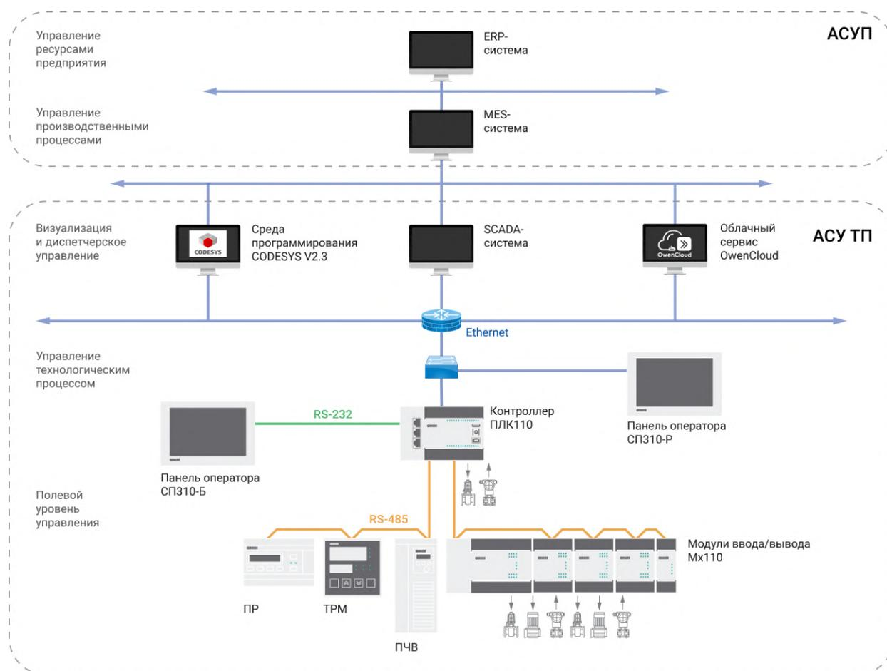
**Рисунок 6.17 – Пример комплексной архитектуры системы управления**
