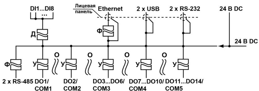
**Рисунок 2.2 – Схема электрической прочности изоляции ПЛК110-24.X.P(M02)**
