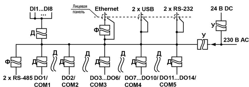
Рисунок 2.3 – Схема электрической прочности изоляции ПЛК110-220.X.K(M02)
