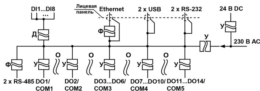
**Рисунок 2.1 – Схема электрической прочности изоляции ПЛК110-220.X.P(M02)**
