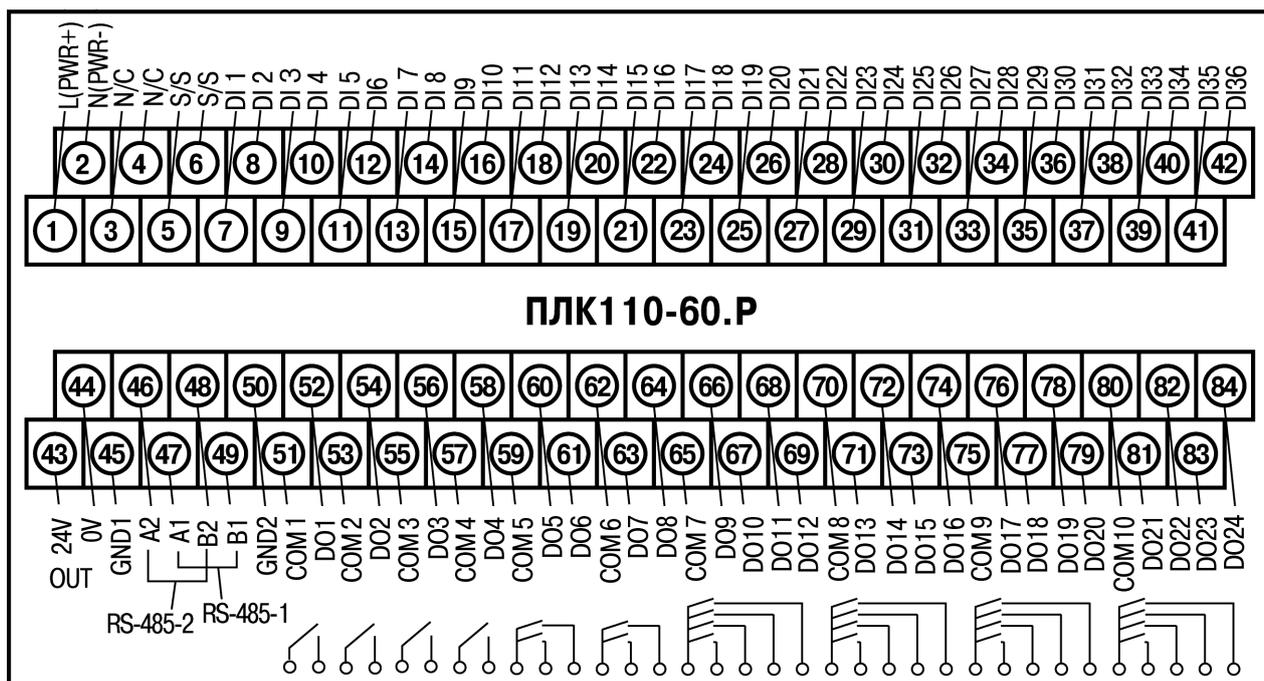
Рисунок 6.5 – Схема расположения и назначение клемм на ПЛК110-220.60.P(M02).
