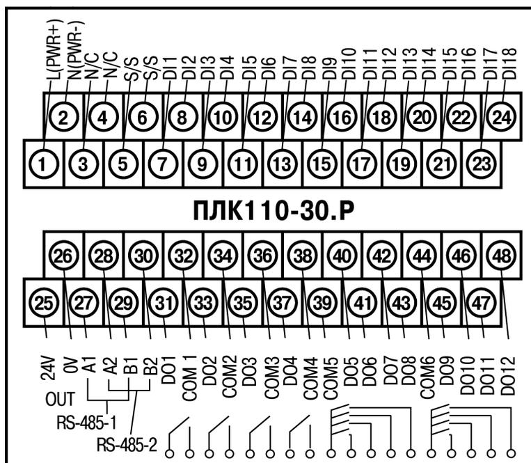
Рисунок 6.1 – Схема расположения и назначение клемм на ПЛК110-24.30.P(M02).
