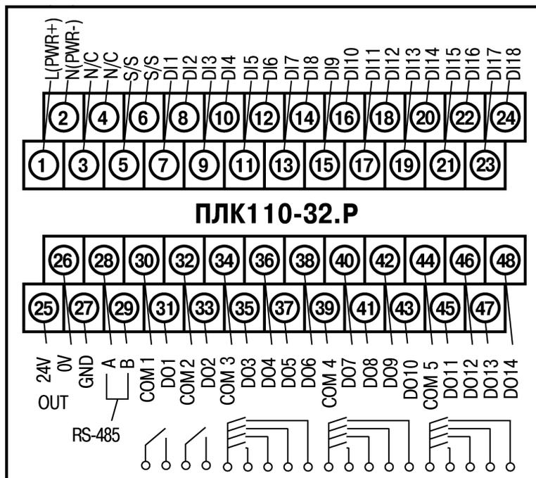
Рисунок 6.3 – Схема расположения и назначение клемм на ПЛК110-24.32.P(M02).
