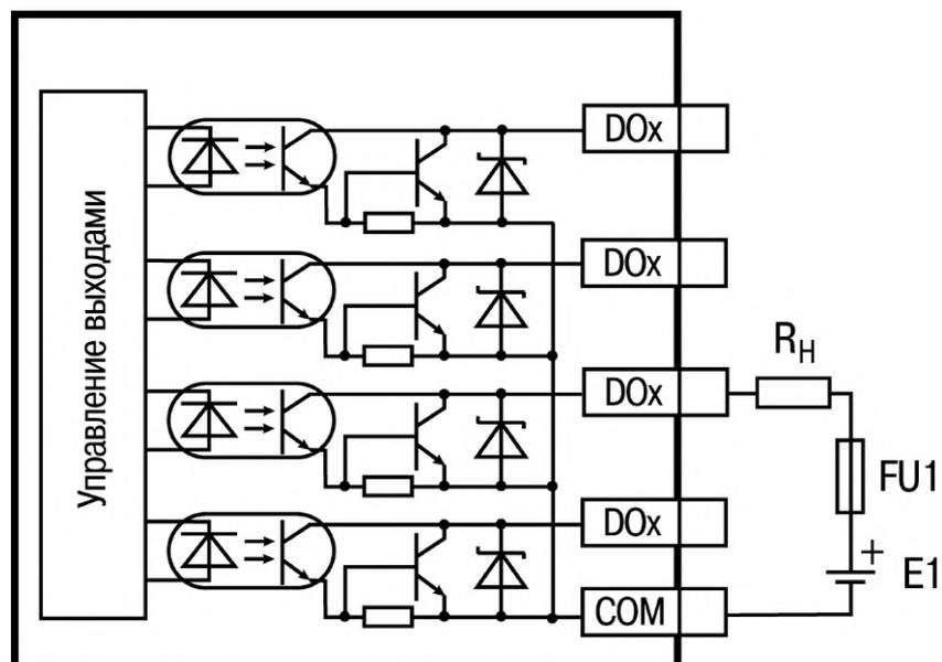
Рисунок 6.10 – Выходные элементы типа К (обычные)
