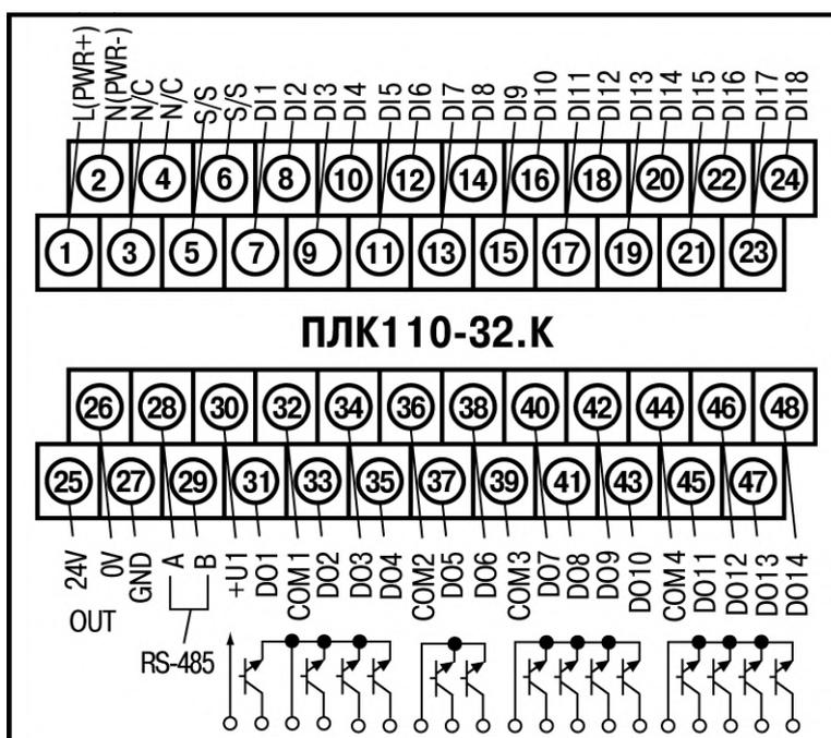
Рисунок 6.4 – Схема расположения и назначение клемм на ПЛК110-220.32.K(M02).
